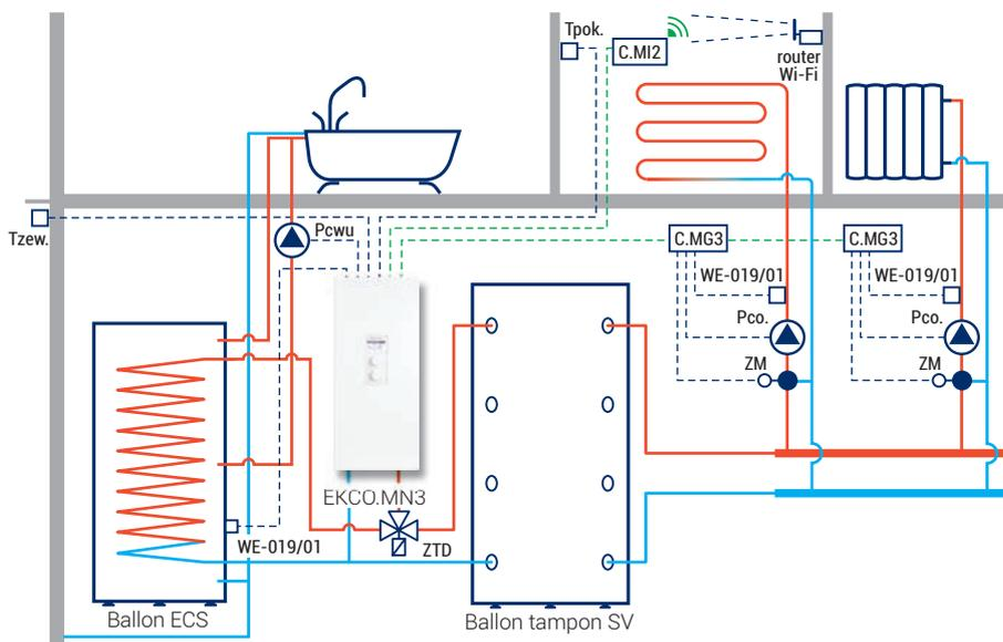
L'utilisation d'une chaudière électrique avec un ballon tampon pour l'accumulation de chaleur assure un chauffage confortable et économique, avec des coûts d'investissement relativement bas.
