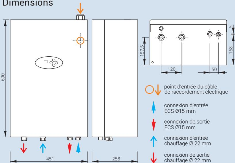
Chaudière mixte pour chauffage central et chauffage d'ECS instantanément
