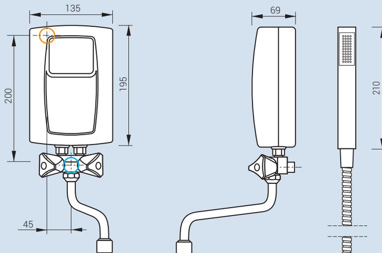
Raccordement d'eau M: 1/2"
