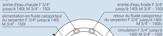
Ballon préparateur ECS avec le serpentin - raccords en haut pour le montage dessous d'une chaudière
